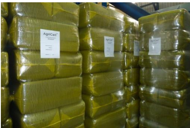
Fertig abgepackter Faserstapel. Beim Einbau wird er aufgelockert und mit einer Maschine eingeblasen.
